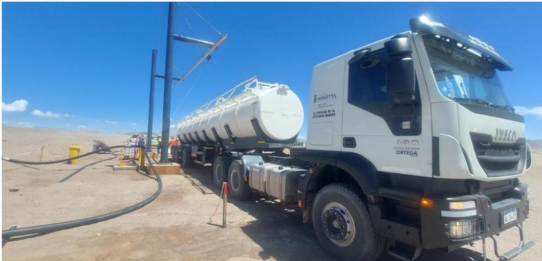
Actualmente, el 40% de la flota de Mogetta se encuentra compuesta por unidades IVECO, incluyendo los Trakker 480 6x4, especialmente equipados para transportar salmueras concentradas en cisternas de hasta 37 toneladas, desde las piletas de evaporación hasta las plantas de procesamiento. *“Trabajamos a 4.000 metros de altura, donde otros equipos suelen perder potencia. El Trakker es el que mejor rendimiento nos dio, no pierde potencia en esas condiciones”*, concluyó Moguezza.
