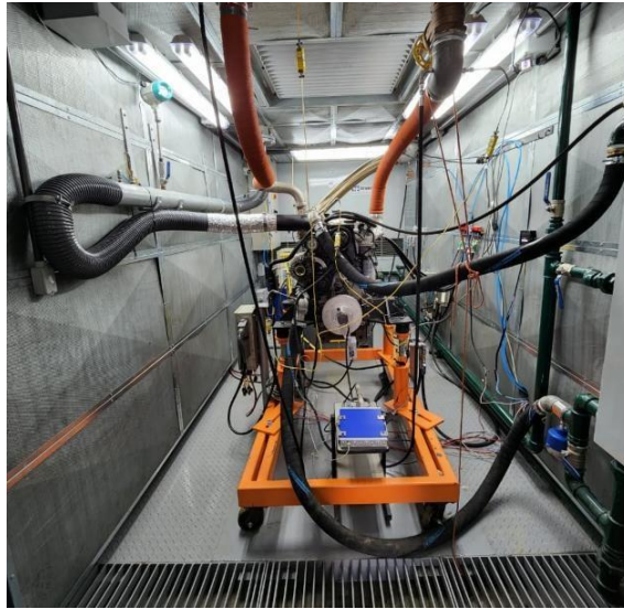
Motor conceito N67 Dual-Fuel testado pela UNIFEI. Foto: Divulgação
