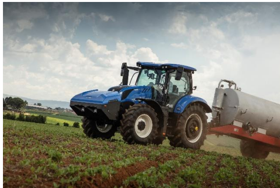
搭载了菲亚特动力科技 (FPT Industrial) N67 天然气发动机的 New Holland 的 T6 甲烷动力拖拉机
